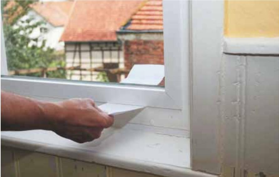
**Abb. 4.11:** Dichtheit des Fensters testen: Klemmen Sie ein Blatt Papier nacheinander an verschiedenen Stellen zwischen Fensterflügel und Rahmen und versuchen Sie, es wieder herauszuziehen. Je leichter das gelingt, desto weniger dicht schließt ein Fenster. Abhängig von Alter und Bauart kann man dann entweder die Scharniere nachziehen (lassen) oder der Energieverschwendung durch Einkleben elastischer Dichtungsbänder einen Riegel vorschieben. (Foto: FLiB e. V.)
