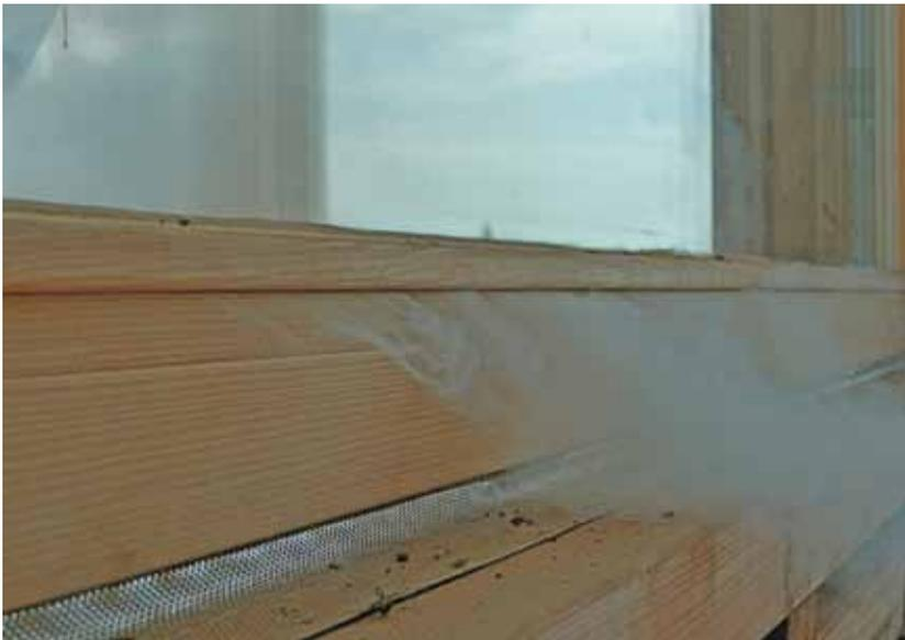
**Abb. 4.13:** Die starke Durchströmung einer undicht verbauten Glasleiste oder einer fehlenden Abdichtung wird hier durch künstlichen Nebel sichtbar gemacht.
