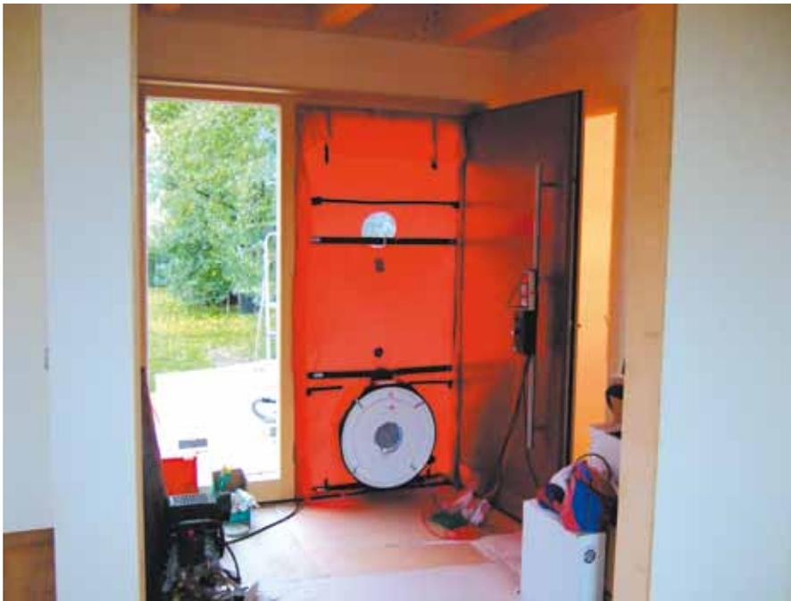
**Abb. 4.66:** Die in einen Hauseingang eingebaute Blower-Door; die Gebläseöffnung wird durch Blenden (weiß) verringert.
