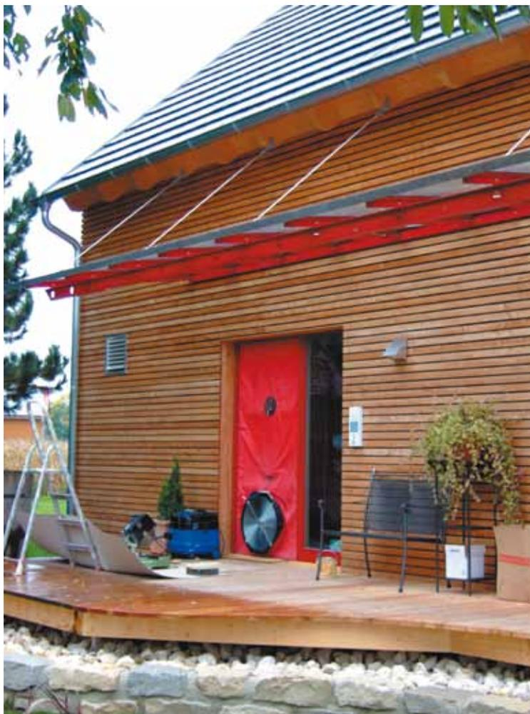
**Abb. 4.65:** Luftdichtheitstest in einem Holzhaus: Das große Gebläse ist mit einem Spannrahmen im Haustürrahmen luftdicht eingebaut.
