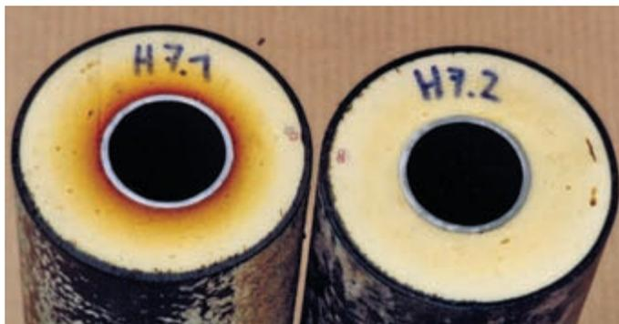
**Abb. 1.2:** Ein Fernwärmerohr mit einer Dämmung aus Polyurethan-Schaumstoff nach 16 Jahren im Einsatz: Beim heißen Vorlaufrohr (links) zeigt sich die erste Verfärbung. Im Lauf der Zeit gelangen Sauerstoff und Stickstoff aus der Luft in die Schaumstoffblasen, gleichzeitig entweicht Kohlendioxid. Dadurch verschlechtern sich die Dämmeigenschaften. (Foto: GEF-Ing. Gesellschaft für Energietechnik und Fernwärme Chemnitz mbH)
