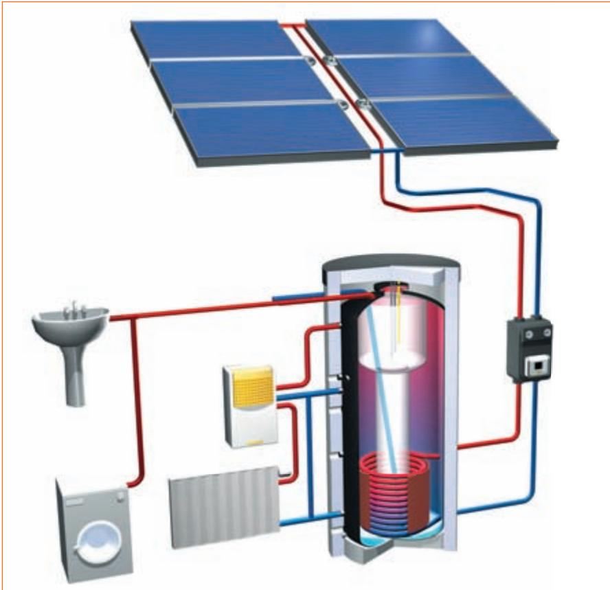
**Abb. 1.8:** Schema der Warmwasserbereitung mit Sonnenkollektoren (Grafik: Wagner & Co, Cölbe)
